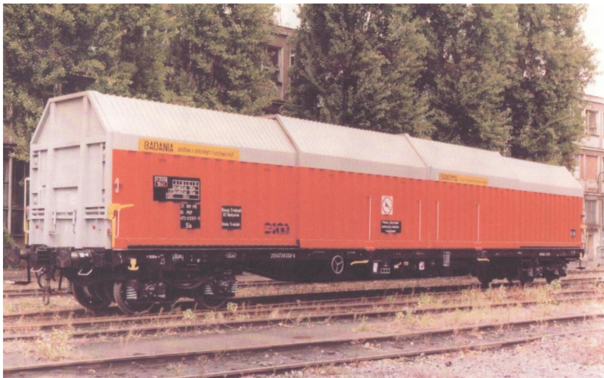
Rys. 7. Wagon towarowy typu 426Sc z wózkami 4RS/N [25].
