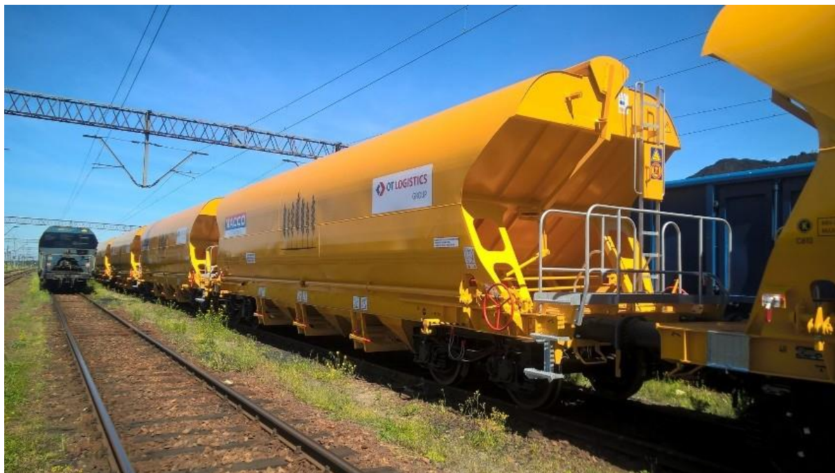
Rys. 4. Do transportu zboża Grupa Kapitałowa OT Logistics będzie wykorzystywać nowoczesne wagony typu Tagnpps, które niedawno wypożyczyła. Masa ładunkowa każdego z nich to ok. 60 ton [20].
