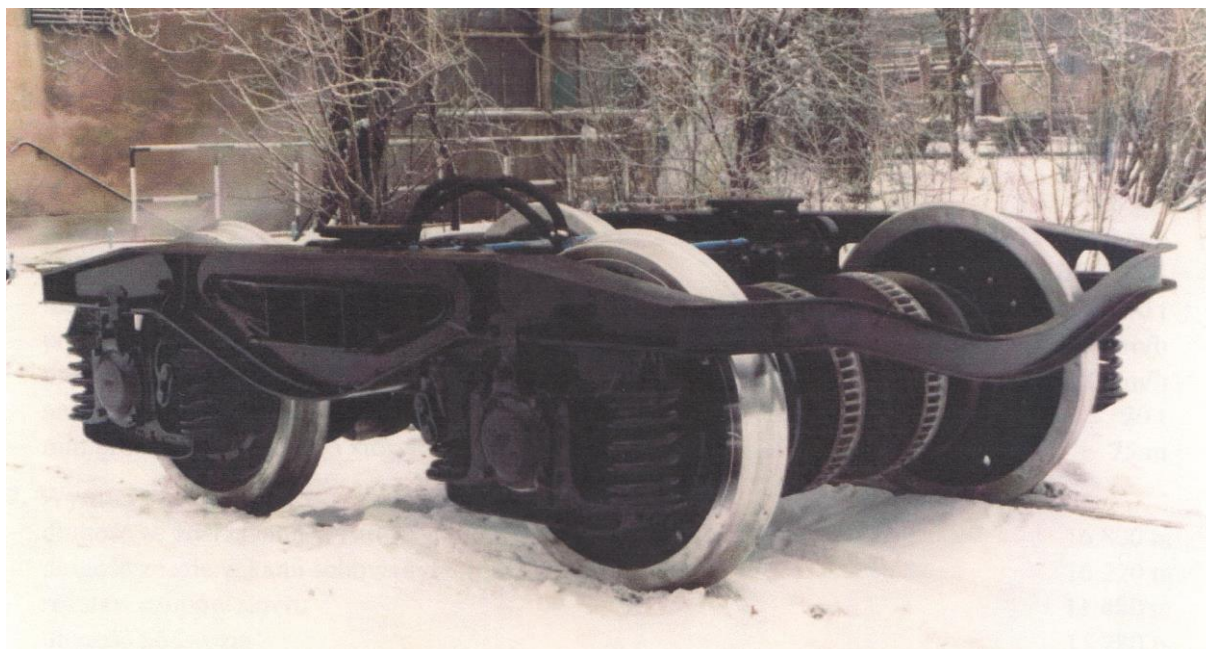
Rys. 6. Wózek 4RS/N do wagonów towarowych o nacisku 20÷22,5 t/os, V=120 km/h [25].
