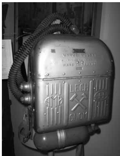
Tlenowy aparat roboczy „Lech-Gnom”, 1939 r. Fot. Jan Woźniak, zabytek ze zbiorów Izby Tradycji Fabryki Sprzętu Ratunkowego i Lamp Górnich „FASER” w Tarnowskich Górach.
