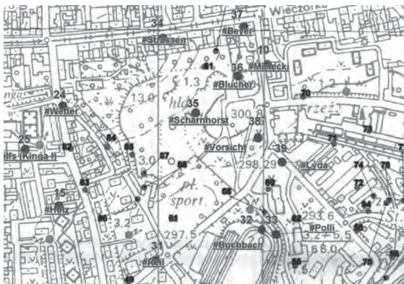
Rys. 6. Inwentaryzacja wyrobisk górniczych mających połączenia z powierzchnią
