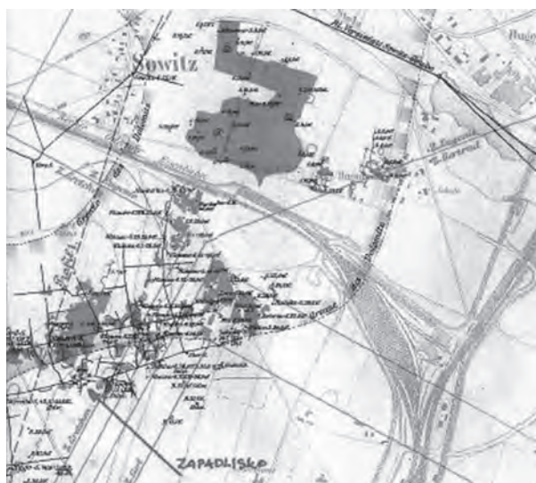
Rys. 7. Zapadlisko powstałe na terenie pogórnym kopalni Siemianowice na skutek dawnej płytkiej eksploatacji złóż rud cynku i ołowiu wraz z mapą archiwalną umożliwiającą badanie przyczyn zjawiska
