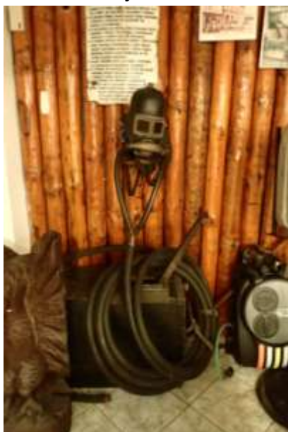
Rys.3. Aparat węzowy Koenig w roku 1910 (zdjęcie - Sala Tradycji OSRG Jaworzno)
