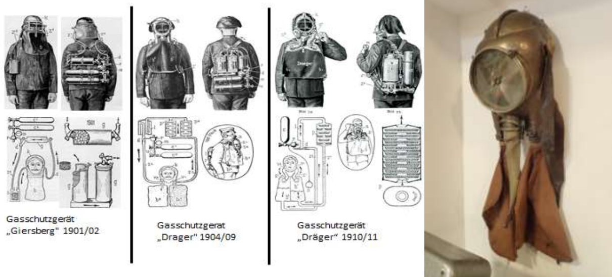
Rys. 4. Aparat oddechowy Dräger 1904 (fotografia :hełm i maska ze zbiorów Sali tradycji OSRG Jaworzno)
