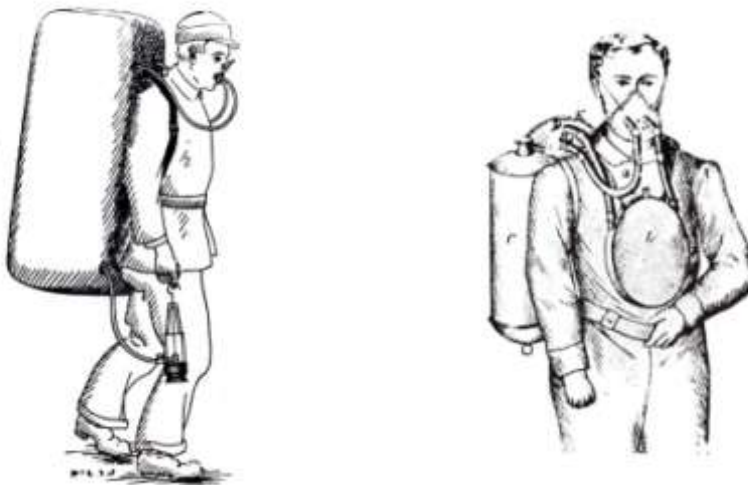
Rys.1. Aparat oddechowy Galiberta 1830 r. (z lewej) i Aparat oddechowy Schwanna 1853 r.(z prawej)
